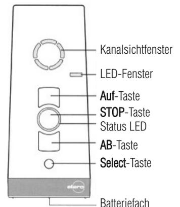
Um weitere Motoren mit dem gleichen Mehrkanalfunkhandsender ansteuern zu können, wählen Sie den einzulernenden Kanal für das gewünschte Element aus, drücken Sie die **Programmier**-Taste und gehen sie wie ab Punkt ⑤ beschrieben vor.
